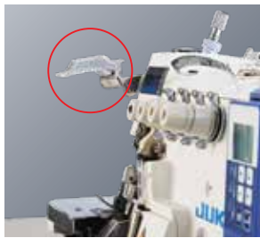
1. Protetor de agulha com sensor de abertura/fechamento
