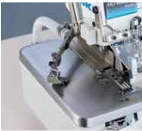
3. Braço do calçador com sensor de abertura/fechamento
