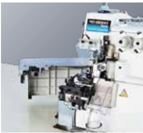
2. Tampa da chapa da agulha com microinterruptor de abertura/fechamento
