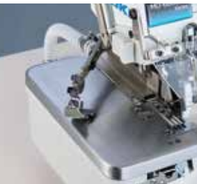
3. Brazo del prensatelas con sensor de apertura/cierre
