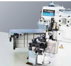
2. Cubierta de la placa de tela con microinterruptor de apertura/cierre
