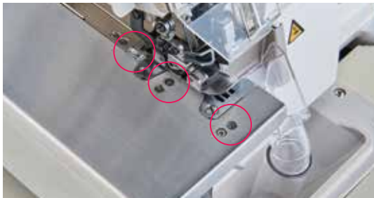
3 sensores de material
