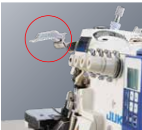
1. Protector de aguja con sensor de apertura/cierre
