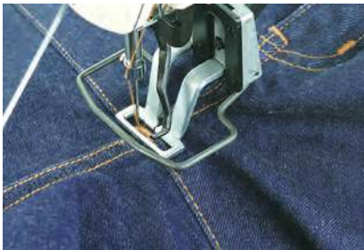
Tipos H, W (Bartacking de la entrepierna de los jeans)
