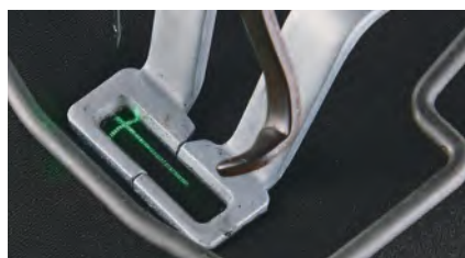
Ejemplo de la guía de hilo tipo H instalada.
