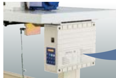
Caja de control y panel de operación.
